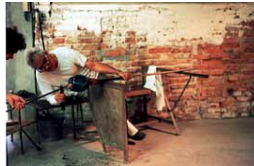
Figura 4. Aplicación del puntel
