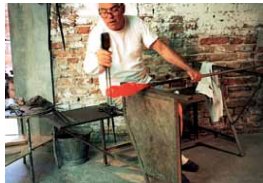
Figura 2. Proceso de modelado de una pieza soplada
