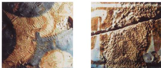
Figs. 5 y 6 Plegados por efecto del calor y abrasiones con textura de piel de naranja en el vidriado del jarrón de las Gacelas
