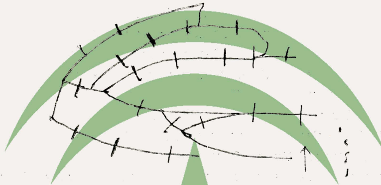
Fig. 1.—Un detalle del despiece de las maderas de los techos abovedados de la Sala de los Reyes.
